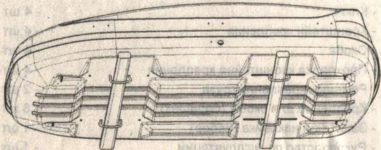
С внутренней стороны корпуса бокса на концы скобы наденьте прокладку кронштейна крепления.
