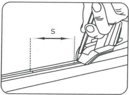
4. Отмерьте указанное расстояние на пластиковых линейках. Отрежьте линейки.
