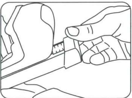
8. Поставьте собранные дуги с опорами на рейлинги, затяните винты опор.
