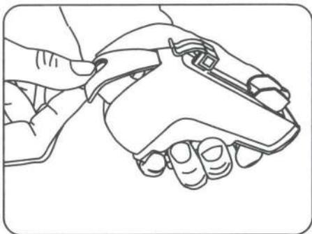
3. Соедините опору с поперечной дугой. Для этого в паз дуги вставьте верхнюю часть прижима и передвиньте опору по дуге на 10-15 см.
