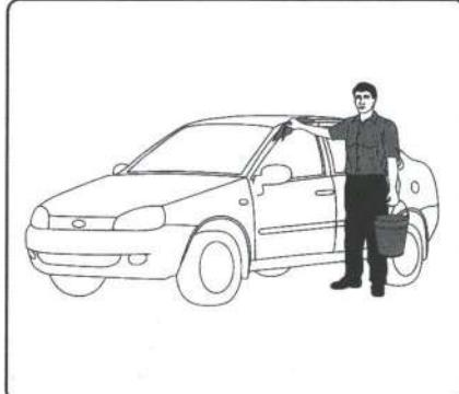
4. В местах установки опор багажника очистить крышу автомобиля от загрязнений.
